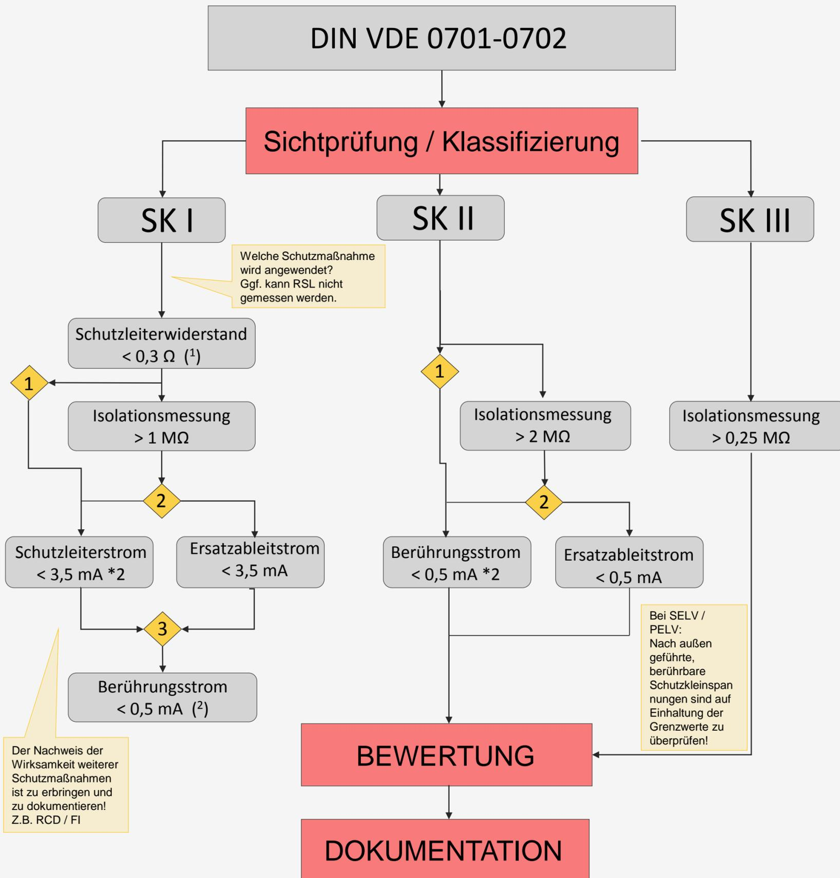
1 Bei Anschlussleitungen bis maximal 5m., zzgl. 0.1  $\Omega$  je weitere 7,5m aber max. 1 $\Omega$ . Bei Geräten mit einem Nennstrom > 16 A muss der Grenzwert anhand der Leiterlänge des Leiterquerschnittes und Material des Leiters berechnet werden.
